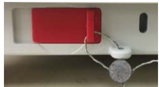
Bloqueado con cable de sellado
