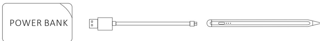
**Nota:** El indicador led encenderá un punto si la batería está entre el 5% y 30%, encenderá 2 puntos si está entre el 30% y 70%, o encenderá 3 puntos si está entre el 70% y 100%.
