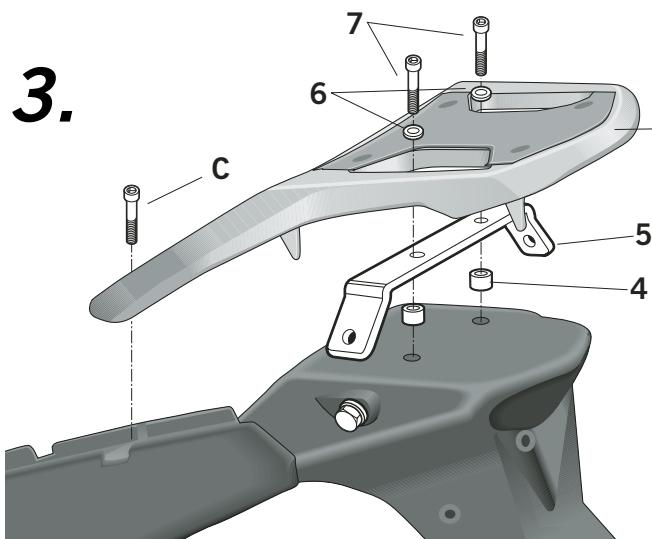
(E) Colocar los distanciadores (4), montar el pasamano soporte unión (5) y el transportín original (B), fijarlo todo mediante las arandelas (6) y los tornillos (7), y por último los tornillos (C).
