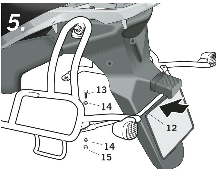
(E) Montar el soporte varilla unión (12) mediante los tornillos (13), las arandelas (14) y las tuercas (15). Realizar la conexión de los intermitentes incluidos en este KIT, fijar los cables con las bridas (16).
