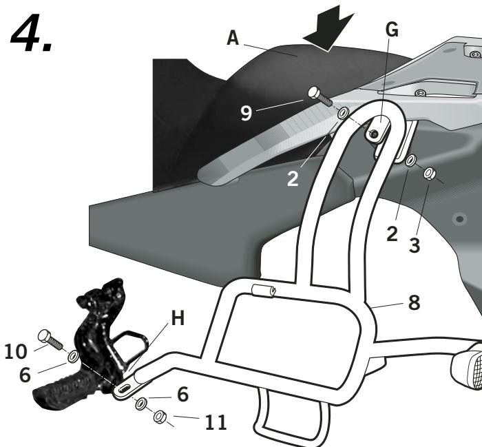
(E) Montar el asiento (A). Montar los soportes KIT FULL (8) en zona (G), mediante los tornillos (9), las arandelas (2) y las tuercas (3) y en la estribera zona (H), mediante los tornillos (10), las arandelas (6) y las tuercas (11).
