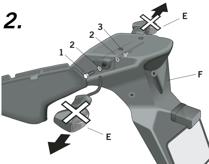
(E) Desmontar y desestimar los intermitentes (E), para ello deberá desmontar el embellecedor trasero (F), montar en lugar de los intermitentes los tornillos (1), las arandelas (2) y las tuercas (3), esto impide que el piloto de freno se descuelgue. Proseguimos montando el embellecedor trasero (F).
