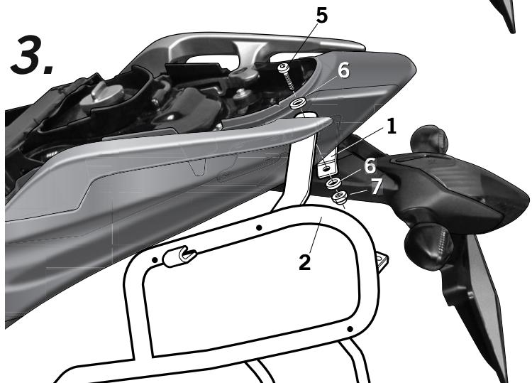
(E) Montar los soportes KIT SIDE (2) a la pieza central (1) mediante los tornillos (5), las arandelas (6) y las tuercas (7).
