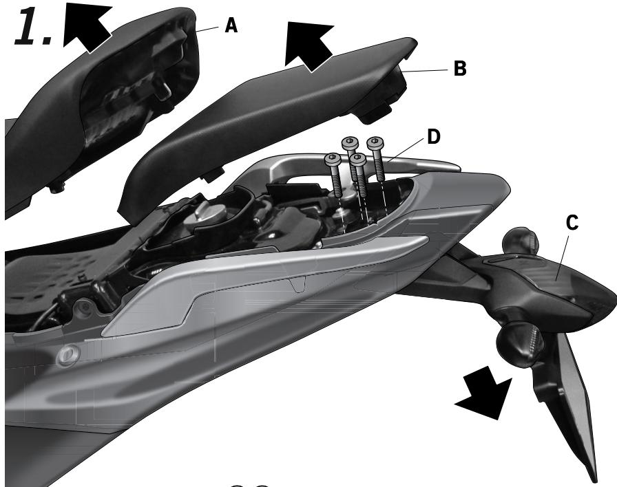
(E) Abrir el asiento delantero (A). Desmontar el asiento trasero (B). Desmontar el guardabarros trasero (C), mediante los tornillos (D).
