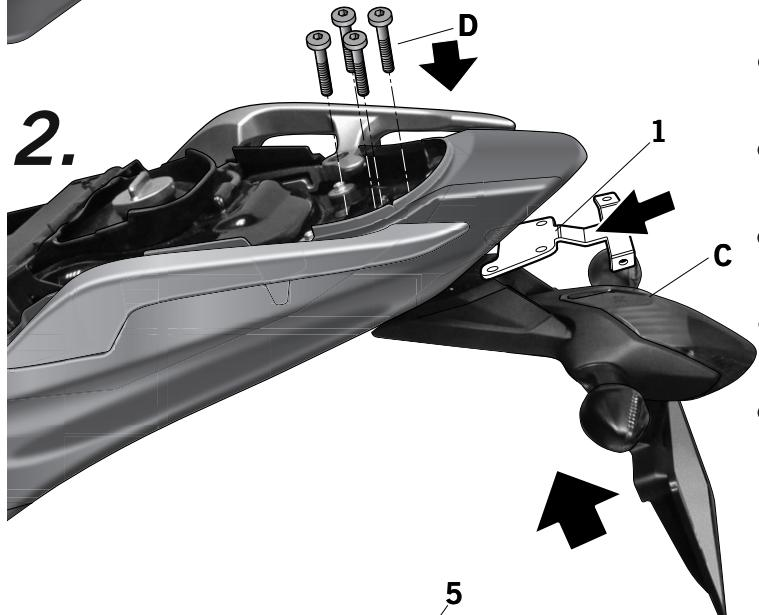
(E) Montar la pieza central (1) según dibujo, al mismo tiempo que montamos el guardabarros trasero (C) mediante los tornillos (D).
