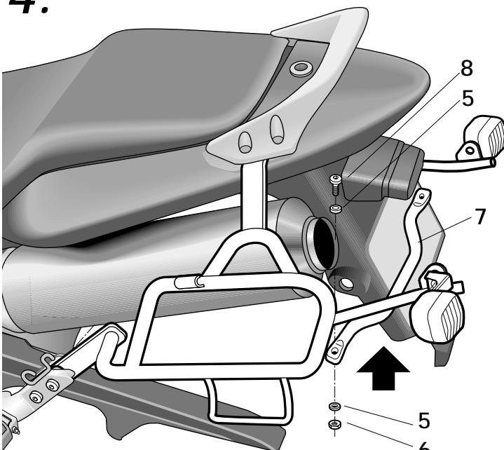
(E) Montar el tubo unión soportes (7) a los soportes KIT FULL (1) y fijarlos con los tornillos (8), arandelas (5) y tuercas (6).
