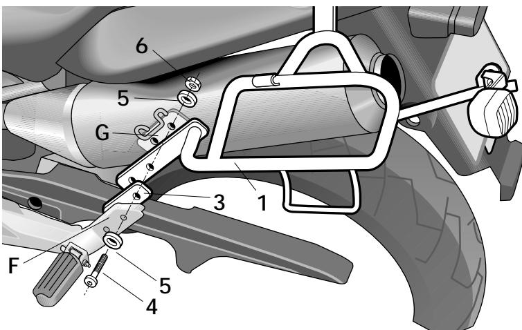
(E) Y en zona (F) mediante el pasamano de grueso (3), el soporte de protección (G), los tornillos (4), las arandelas (5) y las tuercas (6).
