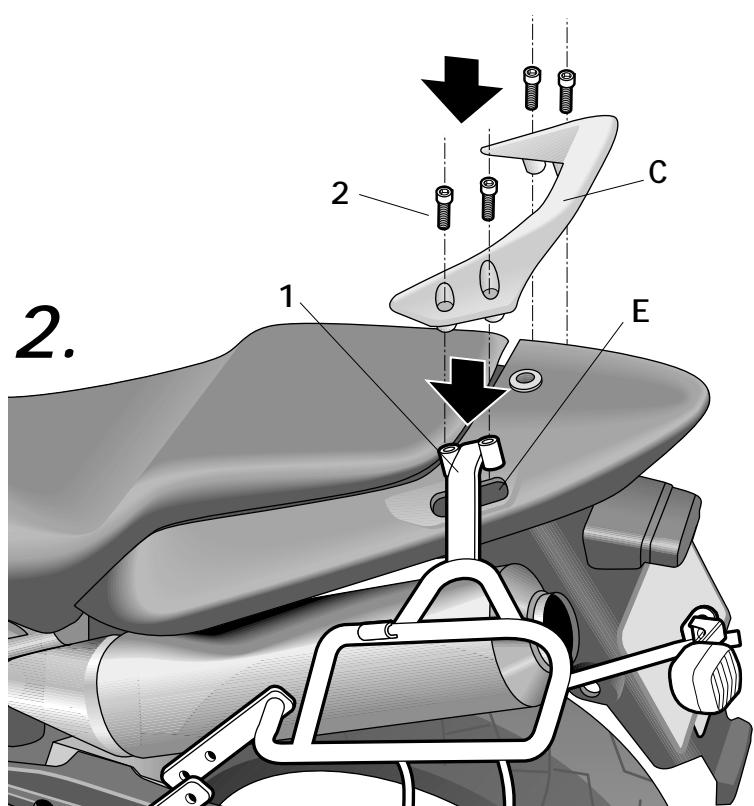
**(E)** Desmontar y desestimar los tapones (A) del agarrañero trasero. Desmontar y desestimar los intermitentes (B). Desmontar el agarrañero trasero (C) mediante los tornillos (D), estos tornillos si se desestiman (zona E).
