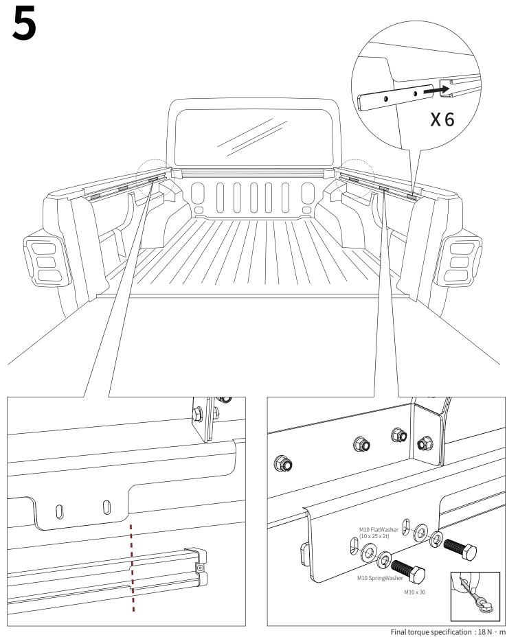
이미지와 같이 차량의 슬롯과 배드랙의 풋을 맞춥니다. Align the vehicle's slot with the bed rack's foot as shown in the image.
