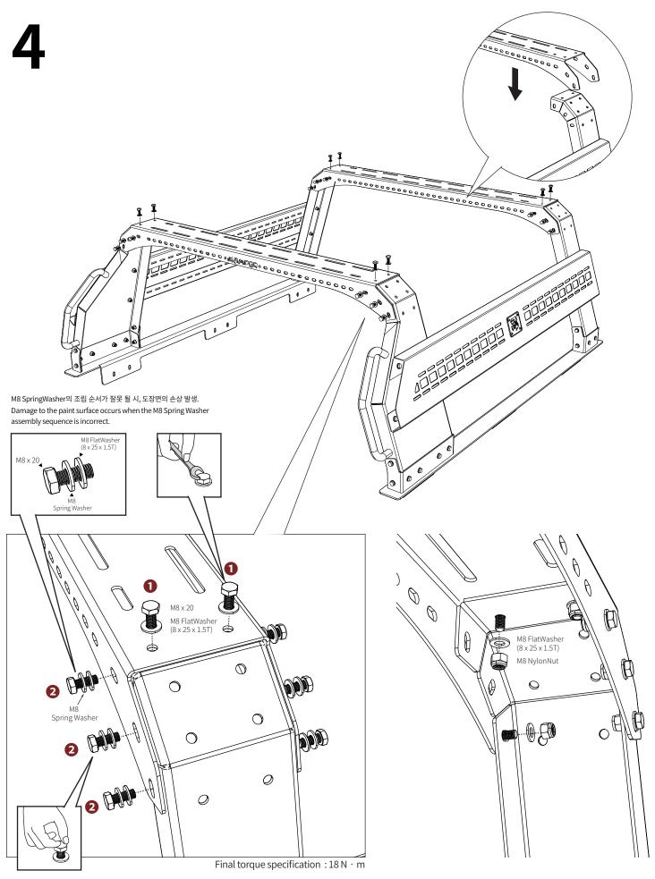
전체적으로 볼트,너트를 손으로만 체결 후 ❶번만 공구로 체결합니다. ※ ❷부분은 차량에 장착시 랙 위치조정이 필요하므로 차량 장착 후 공구로 체결합니다.
