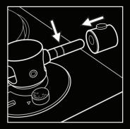
SLIDE THE COUNTERWEIGHT ONTO THE TONEARM UNTIL THE FRONT OF THE COUNTERWEIGHT IS ALIGNED WITH THE BACK GROOVE ON THE TONEARM.
