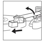
REMOVE THE NEEDLE COVER - LIFT TONE ARM OUT OF THE HOLDER <u>TO</u> <u>THE LEFT SO IT FLOATS</u> <u>FREELY</u> - NOT TOUCHING ANYTHING
