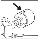
IDENTIFY THE WEIGHT ON THE BACK OF THE TONE ARM. USE THE INCLUDED 2.5MM HEX KEY TO LOOSEN THE SET SCREW
