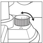
ONCE THE COUNTER WEIGHT IS SET, ADJUST THE ANTI-SKATE CONTROL TO <u>THE RECOMMENDED</u> <u>SETTING OF "1.5"</u>
