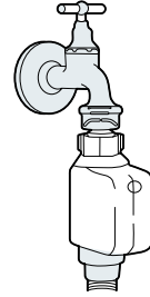
Ống cấp nước an toàn
