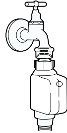
Ống cấp nước an toàn
