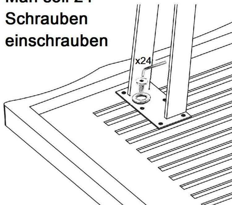
Jedes Bein mit Schraube und Unterlegscheibe montieren. Schraube handfest anziehen.
