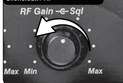
Ajuster le bouton de gain de silencieux / RF
