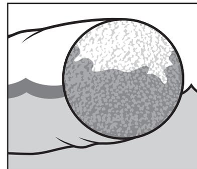
A medida que se absorbe el derrame, la barrera flotante se hunde en el agua. El aceite queda así expuesto a una superficie absorbente fresca.
