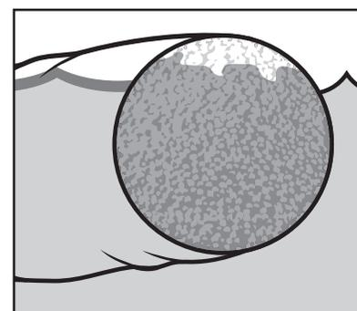
Cuando se satura por completo, la barrera flotante "se ve" justo por debajo de la superficie del agua. (Se debe reemplazar la barrera). Se mantiene la absorción del fluido, y la recuperación es sencilla.
