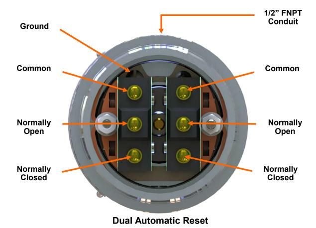
Single Pole Double Throw 15A—125, 250 or 480 VAC, 2A—600 VAC 1/8 HP—125 VAC, 1/4 HP—250 VAC 1/2A—125VDC, 1/4A—250 VDC
