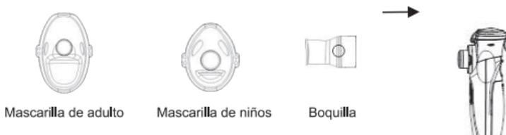
**Figura 5 Colocación de los accesorios**
