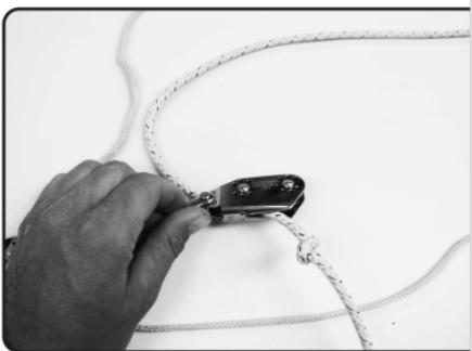
6. Führe den Tampen nun durch den oberen 244 BLK Block. Führe ihn von der Klemme um die Rolle, die am weitesten von der Öse entfernt ist.
