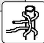
Der nächste Schritt ist das Trimmsystem am Segel anzubringen. Knoten den 100 cm langen 4 mm Spektra Tampen mit Hilfe eines Webeleinsteks um den Mast, wie auf der Zeichnung abgebildet.
