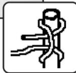
図にあるカウヒッチで100cm 4mmスペクトラロープをマスト回りに巻きます。
