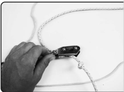
6. Passez l'autre extrémité du bout dans le bloc poulie 244 BLK supérieur, au niveau du réa inférieur comme indiqué sur la photo.
