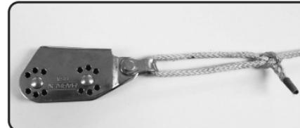
2. 140cm 4mmスペクトラロープを244BLKの同じ箇所に取り付けますが、反対側に向けシートを引き、外側にシートが長く伸びるように設置します。(シートの位置は青いフォームの横ではありません) ボーラインノット(もやい結び)を使い固定しますが、ループの大きさは244BLKより小さくしてください。
