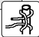
El próximo paso será ponerlo en la vela. Ate el cabo de 100 cm. x 4mm. Spectra alrededor del mástil con un nudo as de guía como se muestra en la foto.
