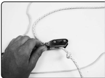
6. 244BLKの上部に輪を作ります。クリートからのシートを外側からローラーに通し、接続箇所に固定します。
