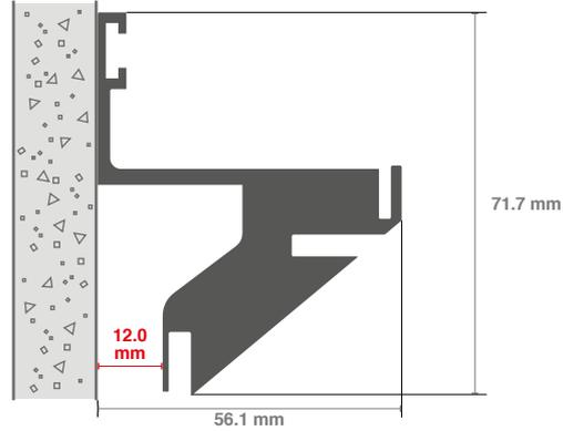
Équerre pour profilé 24 mm | Corner bracket 24mm | Winkel für Profileiste 24 mm
