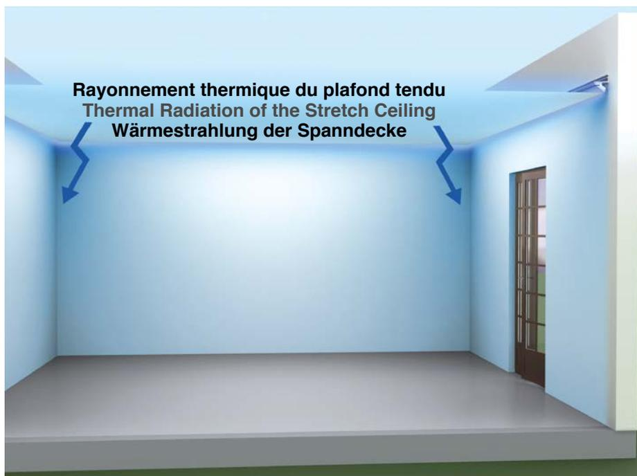
**4** Principe de fonctionnement détaillé | Detailed operating principle | Detailliertes Funktionsprinzip
