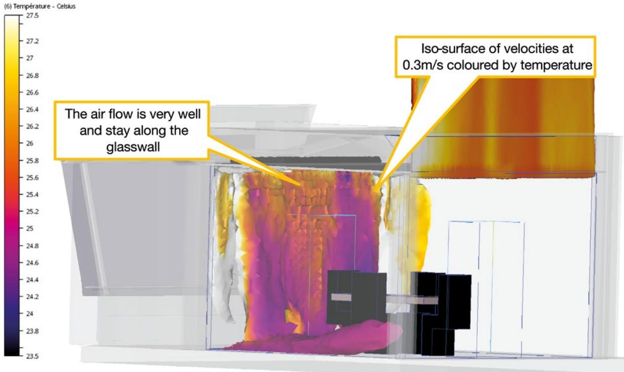
Les tests menés sur le système de diffusion Barrisol Clim® ont permis de valider que via un bon calibrage de certains critères (comme la température de soufflage d'air dans le plénum, la vitesse d'air en sortie du profilé Barrisol Clim®, la position des profilés Barrisol Clim® ouverts, le débit d'air soufflé dans le plénum, etc) il était systématiquement possible d'atteindre un confort **AAA**.
