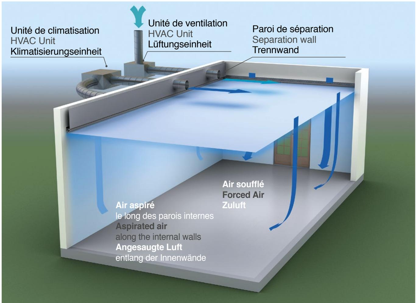
L'ensemble de l'air climatisé et de l'air de ventilation sont diffusés le long des parois, permettant au système Barrisol Clim® d'assurer la climatisation et la ventilation de la pièce, via le rayonnement thermique de la toile et la diffusion d'air périphérique.
