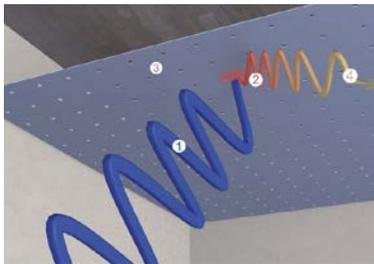
Ce principe consiste à absorber partiellement le mouvement d'air induit par la source sonore grâce aux micro-perforations de la toile qui n'en réfléchissent qu'une partie, cassant ainsi l'effet de réverbération.
