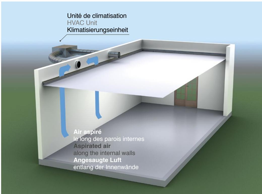
L'air ambiant est aspiré par l'unité de climatisation le long des parois intérieures de la pièce, puis canalisé au moyen d'une paroi de séparation supportée par le profilé spécial Barrisol Clim®.
