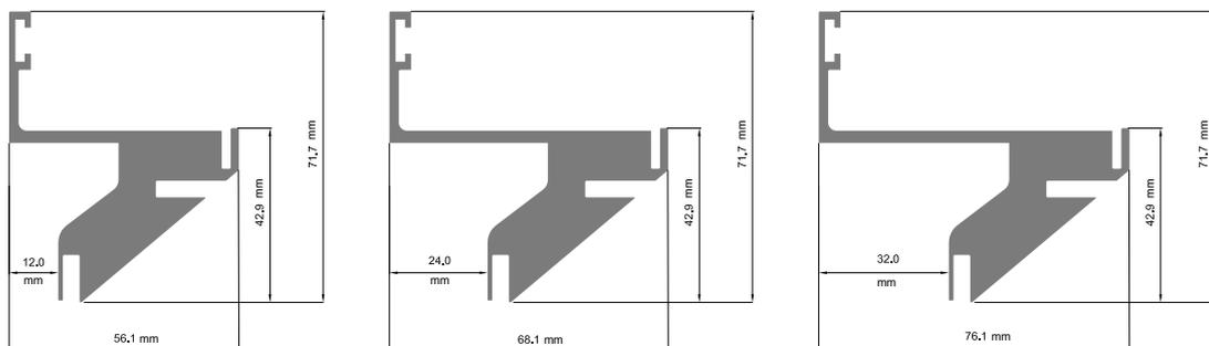
Grâce à sa forme ajourée brevetée, Barrisol Clim® permet un passage d'air en soufflage (a) ou en aspiration (b) entre le volume du plénum et celui de la pièce. La version non ajourée (c) du profilé permet d'interdire le passage d'air sur certains parois.
