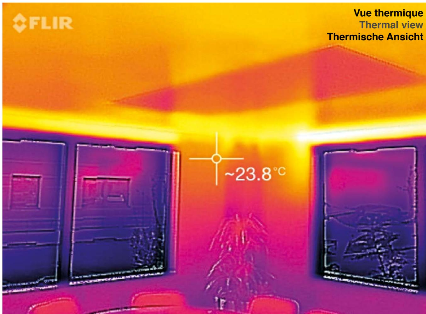
Illustration du rayonnement thermique d'un plafond Barrisol Clim® en mode chauffage
