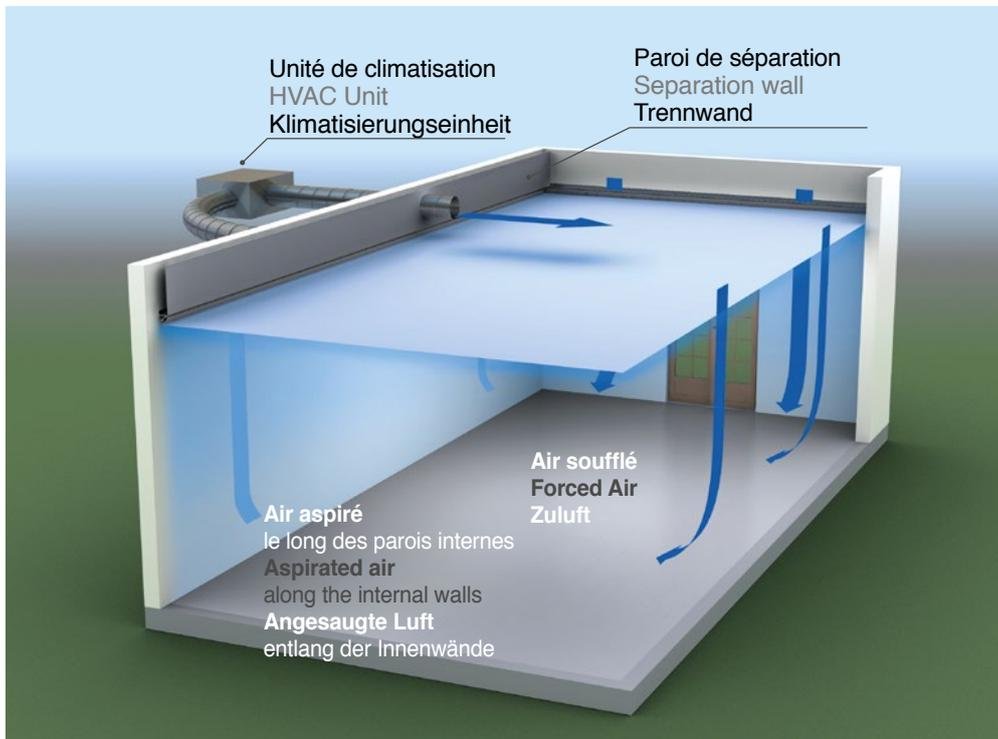
Barrisol Clim® est compatible avec toutes les technologies de ventilation, (simple flux ou double flux). Un caisson de ventilation peut par exemple être connecté au système pour injecter de l'air neuf hygiénique dans le plénum. L'air conditionné et l'air neuf forment un mélange homogène, réparti dans l'ensemble du volume du plénum.
