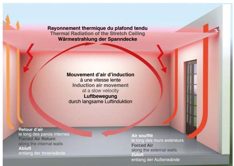
6. Le système Barrisol Clim® fonctionne à la fois grâce au rayonnement thermique du plafond tendu et à une diffusion thermique, par de l'air soufflé, le long des parois de la pièce.
