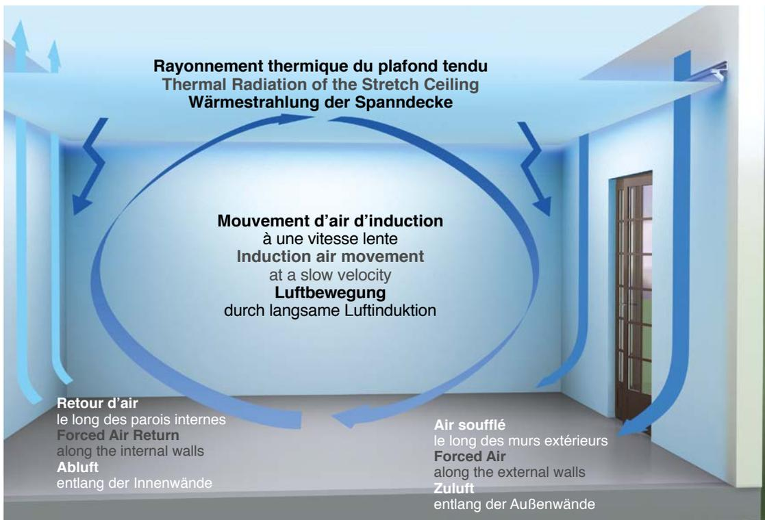
Le système, complètement réversible, fonctionne aussi bien en mode chauffage qu'en mode refroidissement et ce sous toutes les latitudes du globe sans risques de condensation.
