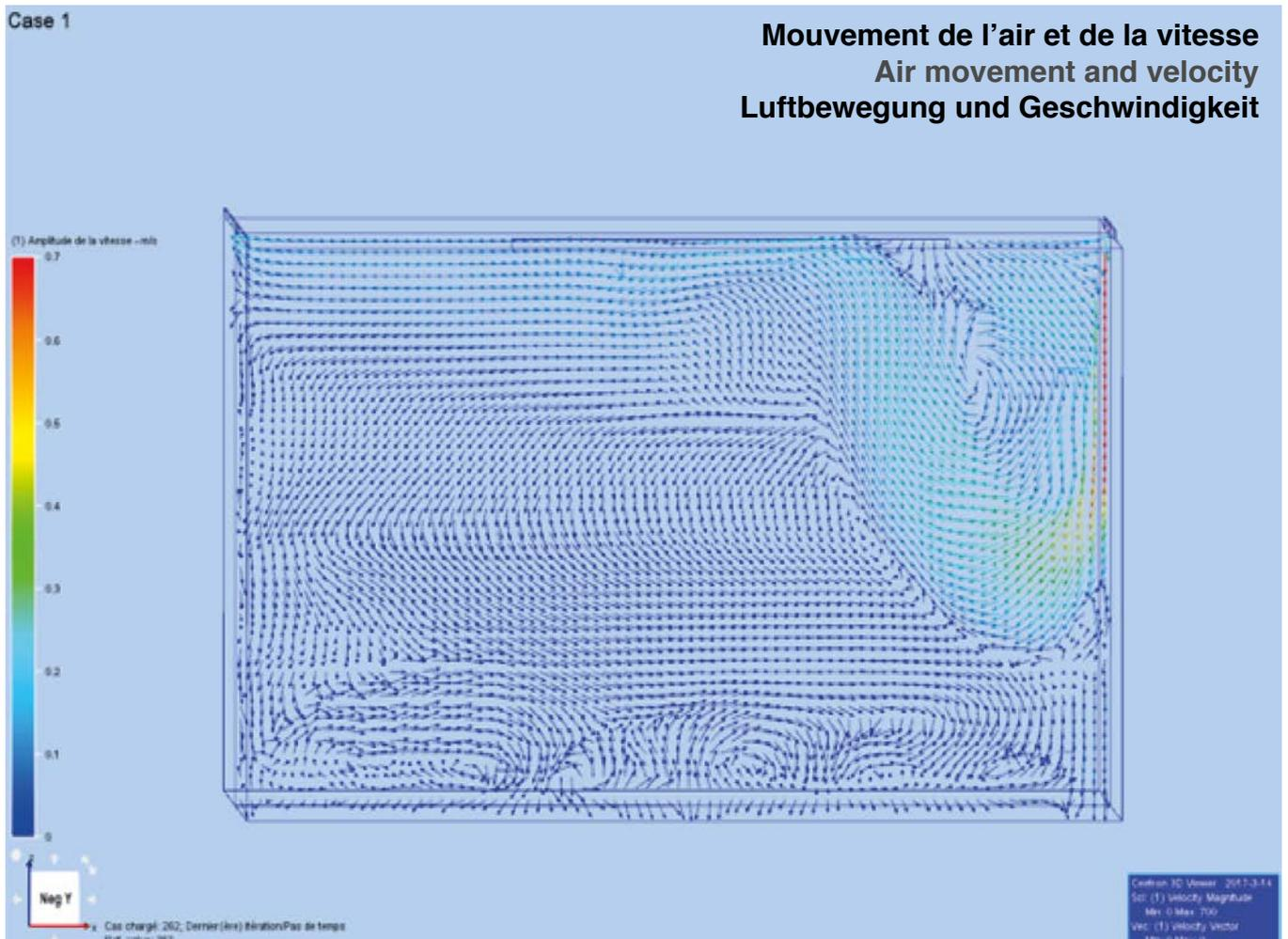
Simulation de l'écoulement de l'air dans une pièce climatisée
