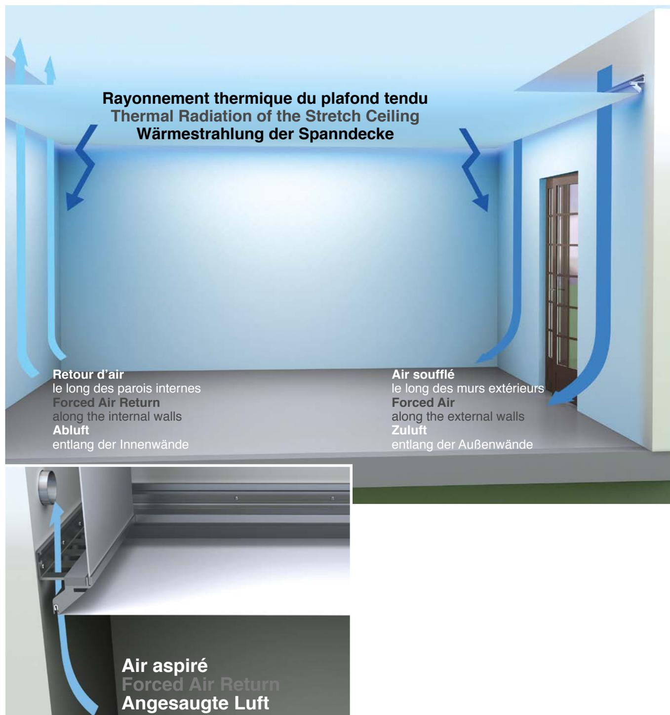
**4** Principe de fonctionnement détaillé | Detailed operating principle | Detailliertes Funktionsprinzip
