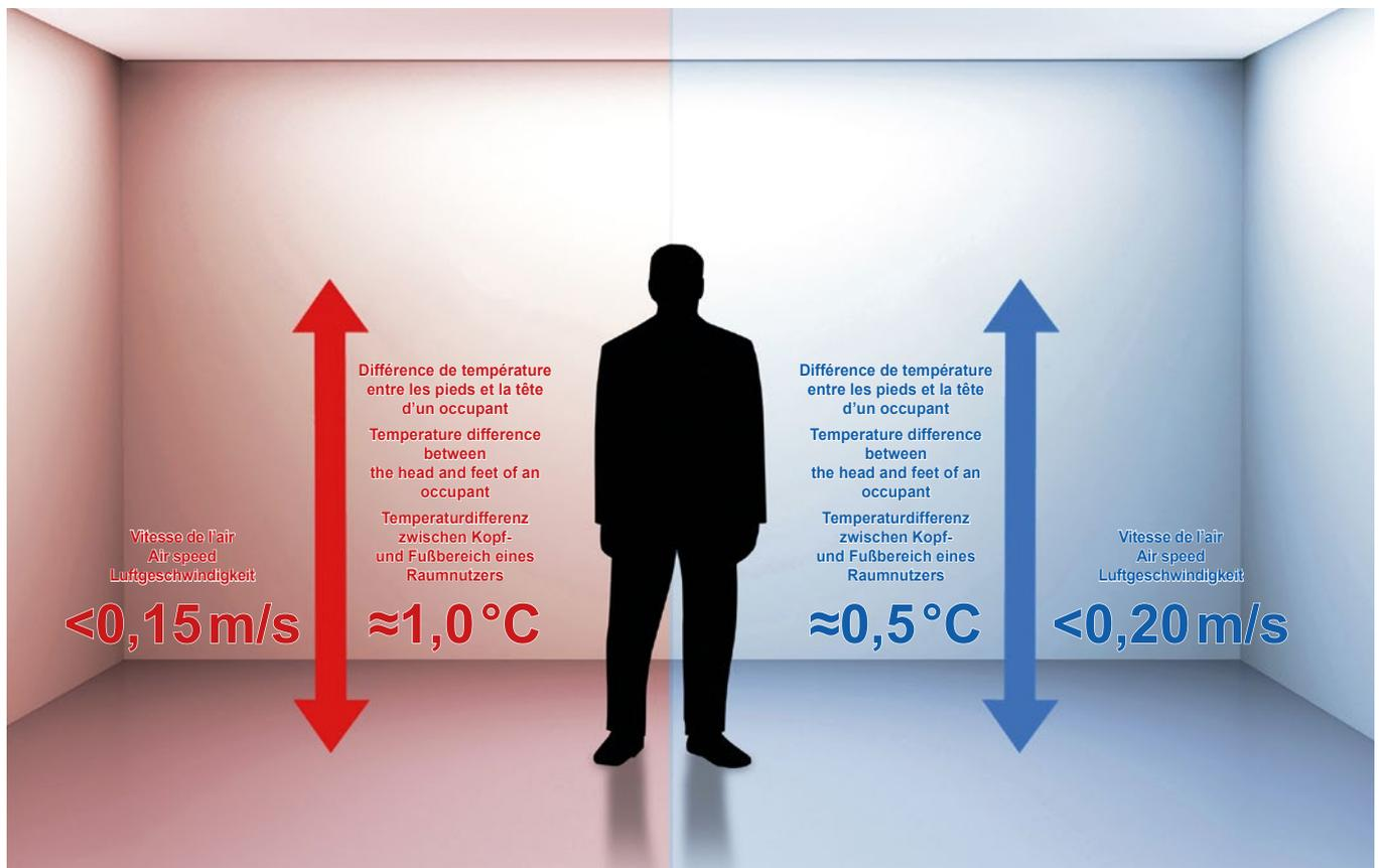
Homogénéité de température et vitesse de l'air
