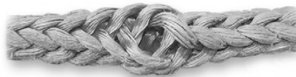
Comprimiendo el Cable a lo Largo
