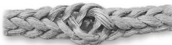
Compression de la corde dans le sens de la longueur
