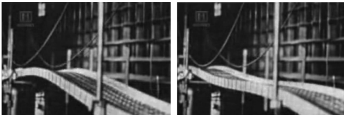
Figura 2.8 – Modelo dinâmico da ponte de Tacoma Narrows
