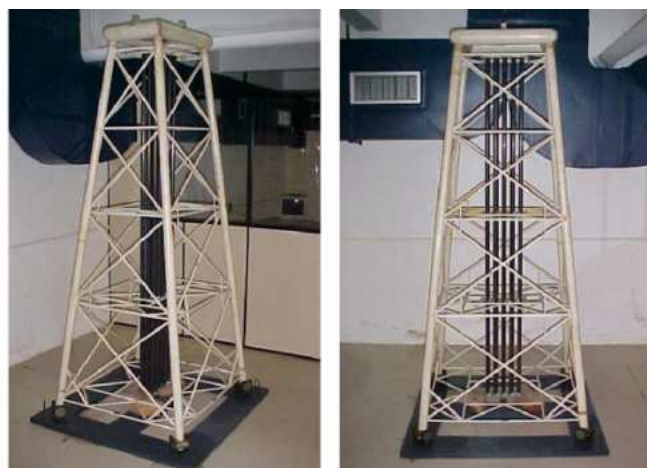
Figura 2.5 – Modelo reduzido em escala 1/45 da plataforma de petróleo Carapeba 3 Fonte: MAGLUTA et al., 2003
