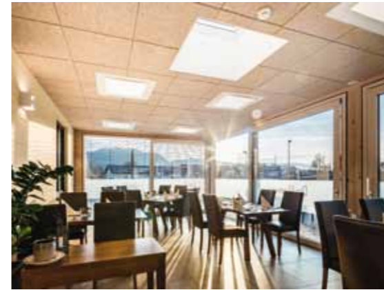
AKUSTIK-PLATTEN AUS HANF IN DER GASTRONOMIE – HIER ALS DECKEN-PANEELE.
