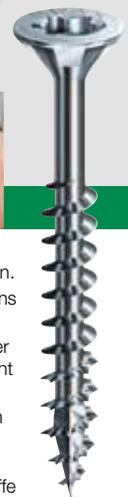
Verschraubung von Platten an Balken. Der gewindefreie Teil muss mindestens so lang sein wie die Materialdicke.
