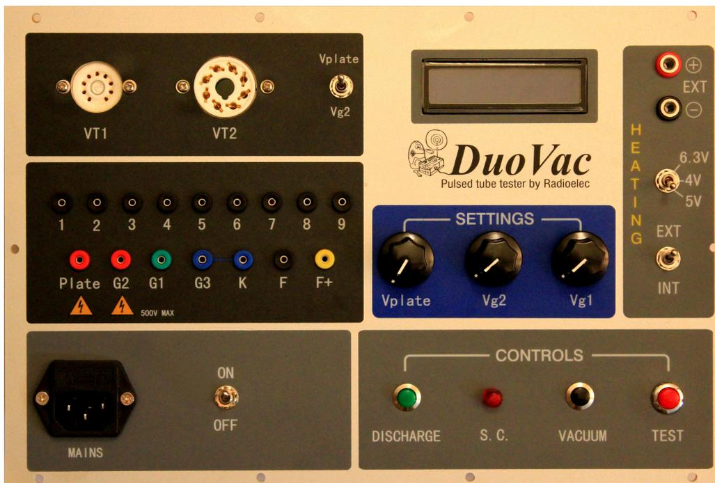
**Beispiel eines möglichen Geräts, welches mit diesem Modul erstellt wurde. Dieses Gerät verfügt über eine Verbindungsmatrix zum variieren des Anschlusses verschiedener Röhrentypen und Ausführungen.**
