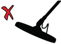
Ángulo incorrecto de la bobina de búsqueda
