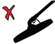
Ángulo incorrecto de la bobina de búsqueda
