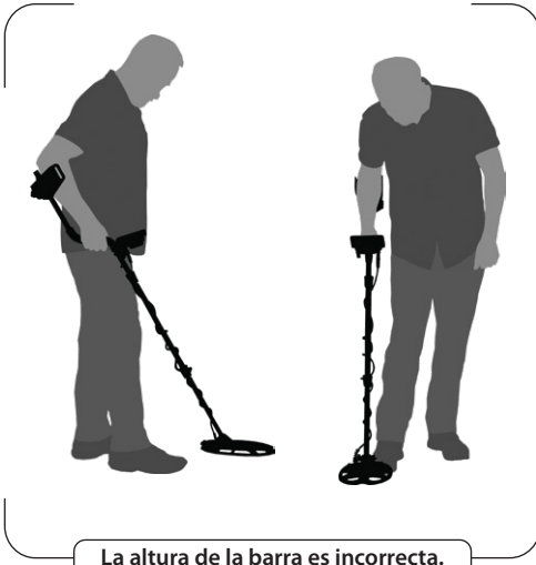
La altura de la barra es incorrecta.
