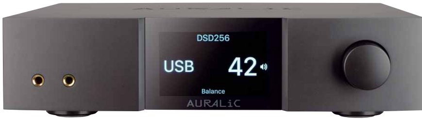
Im DAC-Modus werden Quelle, Format und Lautstärke angezeigt, während beim Streaming auch das laufende Album eingeblendet werden kann
