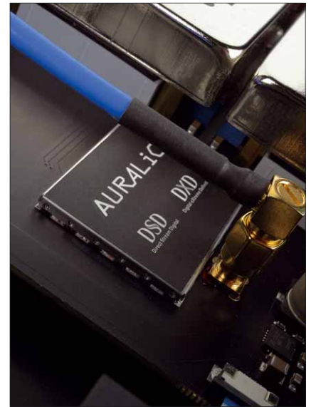
Für den Vega G2 musste ein spezieller DAC-Chip angefertigt werden
