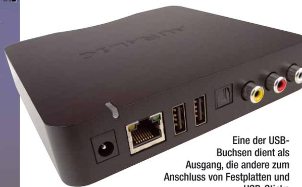
Eine der USB-Buchsen dient als Ausgang, die andere zum Anschluss von Festplatten und USB-Sticks
