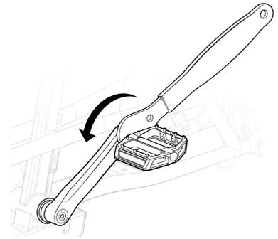
Pédale gauche : dans le sens inverse des aiguilles d'une montre
