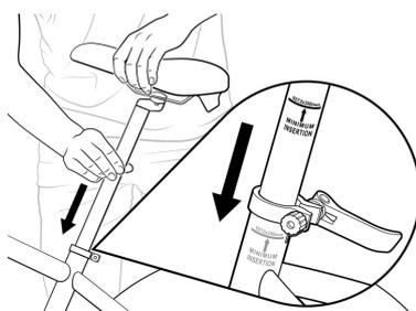
Insérez la tige de selle en vous assurant que le point d'insertion minimum glisse dans le tube de selle.
