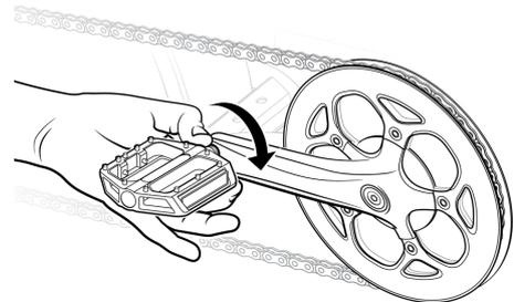
Enfilez doucement la pédale de droite sur la manivelle de droite à la main, en tournant dans le sens des aiguilles d'une montre.
