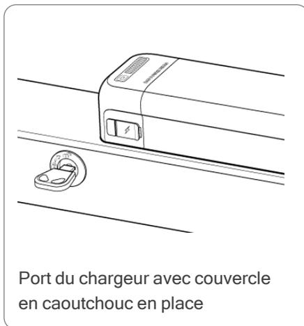
Port du chargeur avec couvercle en caoutchouc en place
