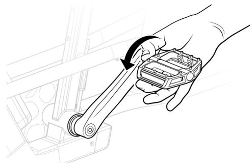
Enfilez délicatement à la main la pédale gauche sur la manivelle gauche, en tournant dans le sens inverse des aiguilles d'une montre.
