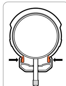
Le talon est l'extrémité dure et arrondie du pneu qui entre dans la jante.
