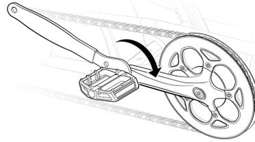
Pédale droite : dans le sens des aiguilles d'une montre
