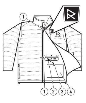
1. CONTROLLER BUTTONS 2. 12V OUTPUT POWER PORT 3. 12V POWER CORD 4. BATTERY POCKET
