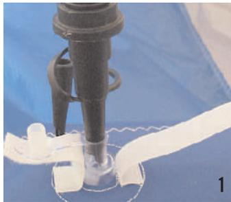
バルブと垂直になるようにポンプを持ちます。片手でバルブをしっかりと固定し、もう片方の手でポンプ操作を行います。
