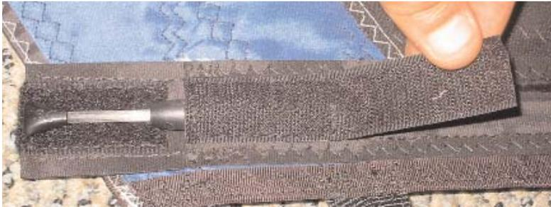
Die Carbon Latten in den Tipps sind normalerweise vormontiert. Sollten sie aus irgendeinem Grund nicht montiert sein, gehen Sie wie folgt vor:
