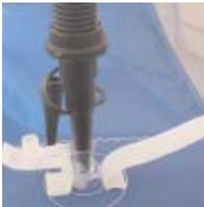
Hadte die pumpe grade zum ventie. Ein hand pumpt, die andere hält das ventil test.
