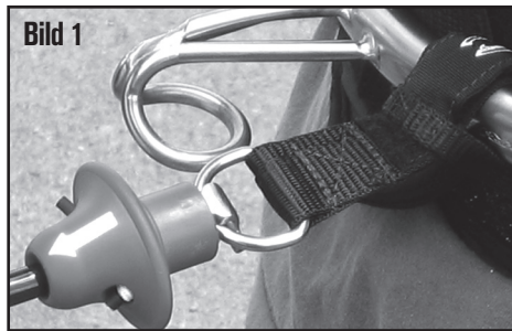
Befestigungspunkt # 1 an der trapezförmigen Edelstahlvorrichtung
