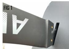
2. Serrer les vis de montage manuellement avec la clé Allen fournie.
