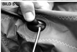
5. Entfernen Sie die Schrauben (2) vom unteren Teil des Ventils. (BILD 5) Bewahren Sie alle Ventiltteile sorgfältig auf, denn Sie benötigen diese später erneut.
