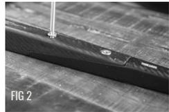
3. Fixer l'aire arrière (Stabilisateur) comme indiqué sur l'image avec les vis M6 15mm, en utilisant votre clé torx T30.
