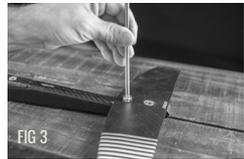
4. Ajustez le mât dans l'encoche du fuselage et serrez les 3 vis de montage M6x30mm.
