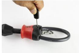
3. Ré-insérez la vis de la tige dans le corps du Quickloop pour éviter de la perdre.
