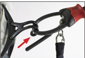
5. Pour connecter le Quickloop au harnais, placez la boucle du Quickloop sur le crochet de votre harnais.
