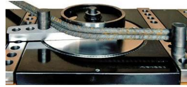
piegatura con il braccio per l'utilizzo dei mandrini fino a diam.450 per PF45 e diam. 500 per PF55.
