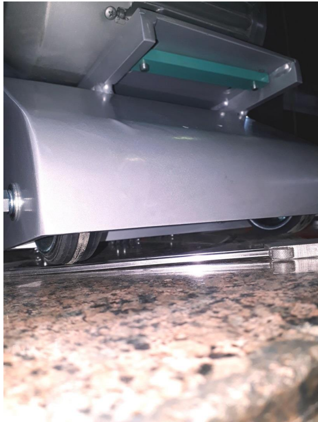
Pyörät eivät ole linjassa. Vasen pyörä on ilmassa.
