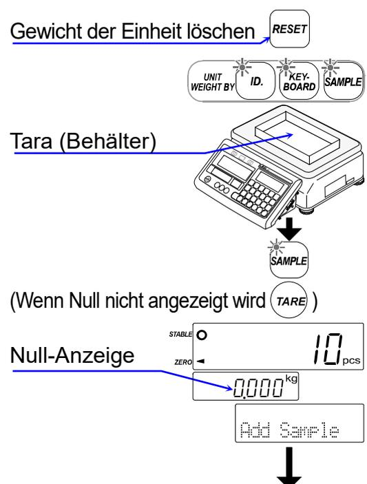
Schritt 3. Legen Sie 10 Proben auf die Waagschale (oder in den Behälter).
