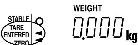
4. La balance soustrait le poids du conteneur et l'afficheur du poids indique le poids net.
