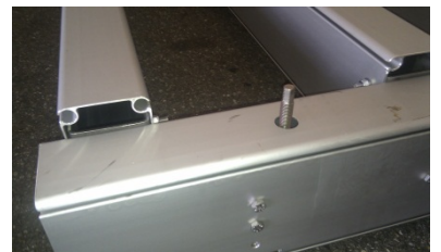
Fit the brake stud
