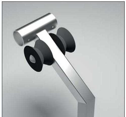
Entfernen Sie als erstes die Plastikkappen aus dem Vierkantröhr. Nun stecken Sie die Welle durch das Loch. Die Distanzscheiben, die Rollen und die Endkappen werden beidseitig aufgesteckt. Anschließend pressen Sie mit Hilfe der Holzkappen die Rollen fest zusammen. Zum Schluss wird die Klimmzugstange mit zwei Schrauben fixiert.
