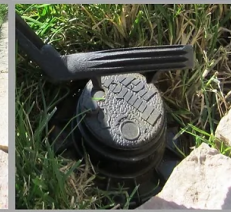
Bottom teeth engage cap fins
