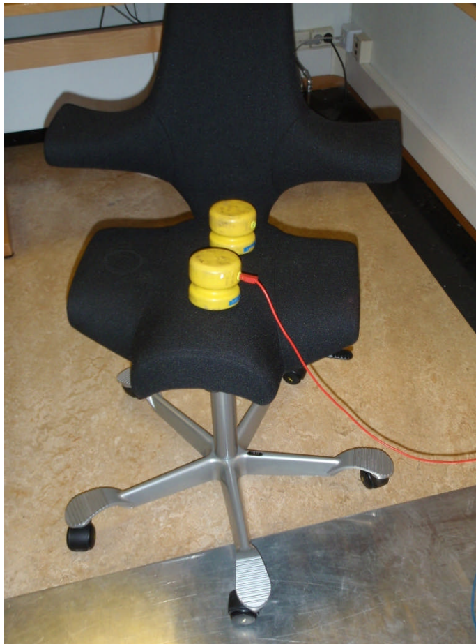
Notes: Måling av motstand til gulv på et hjul
