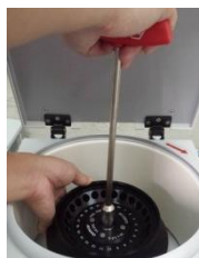
Utensile per rotore con dado
