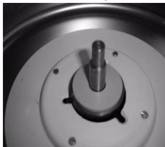
Eje del motor y cámara
