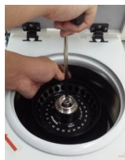
Utensile per rotore senza dado
