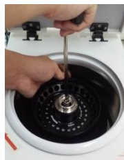
Outil du rotor sans écrou
