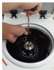
Herramienta para rotor sin tuerca
