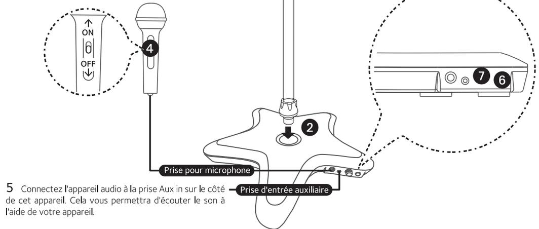
**5** Connectez l'appareil audio à la prise Aux in sur le côté de cet appareil. Cela vous permettra d'écouter le son à l'aide de votre appareil.
