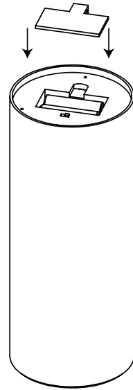
Replace battery door
