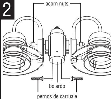
Coloque cada montaje de la Figura 1 al bolardo de base con perno de carro, y la tuerca de caperuza de plástico.
