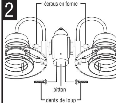
Fixer chaque ensemble de la figure 1 pour borne de base avec un boulon de carrosserie et le plastique écrou borgne.
