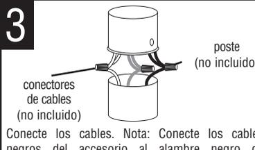
Conecte los cables. Nota: Conecte los cables negros del accesorio al alambre negro de suministro, los cables blancos del accesorio al cable blanco de suministro. No los mezcle. Use conectores de cables (no incluidos). Conecte los cables desnudos de tierra del aparato a tierra de la caja de salida. NUNCA CONECTE UN CABLE A GROUND CABLES DE ALIMENTACIÓN ELÉCTRICA NEGROS O BLANCOS.
