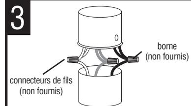
Connectez les fils. Remarque: Fixez les fils noir du luminaire au fil noir d'alimentation, fils blanc du luminaire au fil blanc. Ne pas les mélanger. Utilisez les connecteurs (non fourni). Connectez-fils dénudés de terre du luminaire à la terre de la boîte de sortie. NE JAMAIS CONNECTER FIL GROUND EN NOIR OU BLANC FILS D'ALIMENTATION.
