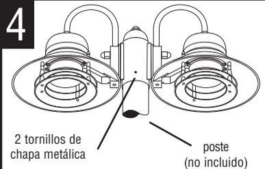
Coloque el aparato sobre el poste como se muestra. Sujete con tornillos en los orificios en el cuello publicación de los agujeros de perforación en el lugar mismo por correo y asegurar con tornillos.
