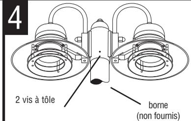
Positionnez l'appareil sur le poteau, comme illustré. Fixez avec des vis au niveau des trous dans le col de poste en perçant des trous au même endroit par la poste et la fixer avec des vis.
