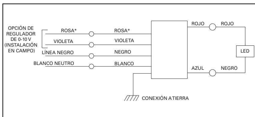
\* Las edificaciones construidas antes de enero de 2022 pueden tener un cable gris para el control de regulación 0-10 V. En estos casos, el instalador etiquetará el cable gris de la edificación como un cable de regulación de 0-10 V y lo conectará al cable de control de regulación de 0-10 V rosa de nuestro producto. Consulte el código NFPA70 (2020 NEC), sección 410.69.
