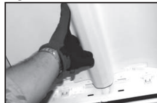
Figura 6. Deslizamiento del reflector en las orejas
