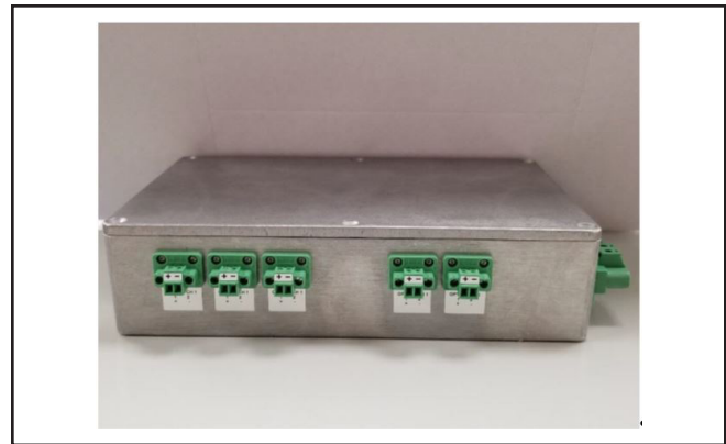
Figura 13. Conexiones de terminales de entrada para la caja de distribución MRI-R6DNLT
