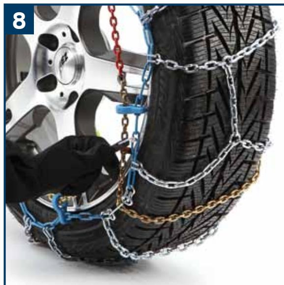
D Das Ende der Spannkette mittels Spanngummis und Haken in leichter Spannung in die Außen- oder Spannkette einhängen.
