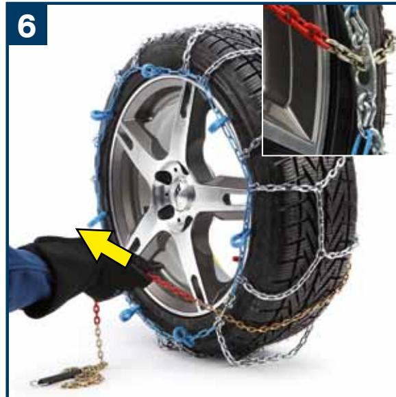
D Spannkette durch die Verschlussplatte ziehen und in Verriegelungsschlitz einhängen. Spannkette in Richtung Verriegelungsschlitz nach oben weiterführen.
