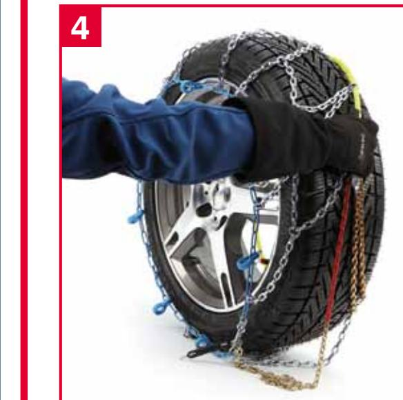
D Kette am Reifen lockern. Ein Ende des Federstahlbügels anfassen und Kette vom Rad ziehen.
