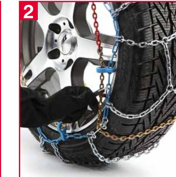
D Kette auf die Fahrbahn fallen lassen und anschließend mit dem Fahrzeug von der Kette fahren.
