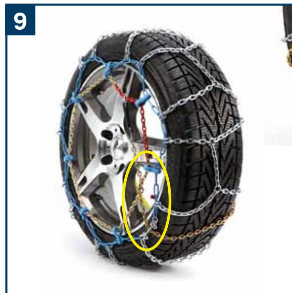
D ACHTUNG: Bei fertig montierter Kette darf der Rollenverschluss (innen) nicht mit der Lauffläche des Reifens/Straßenoberfläche in Berührung kommen. Der rot markierte Bereich der Spannkette muss komplett durch den Verriegelungsschlitz gezogen sein. Je nach Dimension des Reifens kann der Abstand des rot markierten Bereiches zum Verriegelungsschlitz variieren. Langsam losfahren und nach ca. 100 m die Schneekette nachspannen.
