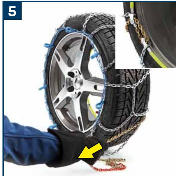
D Spannkette im Bereich der Lauffläche des Rades anfassen und kräftig ziehen, damit sich der Rollenverschluss schließt.
