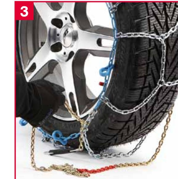
D Spankkette aushängen, durch die Kunststoffösen ausfädeln und durch die Verschlussplatte ziehen.
