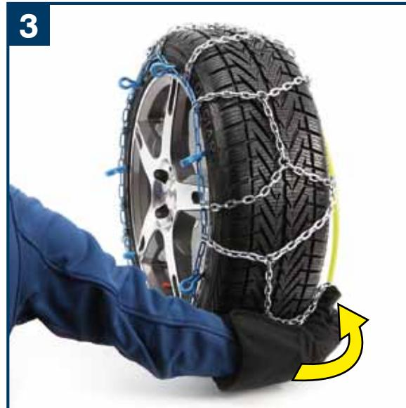
D Danach die Bügelenden unten hinter das Rad schieben, sodass der Bügel zusammenfedorf. Kettenzettel ordnen und darauf achten, dass sich keine Kettenstege im Profil verfangen haben.
